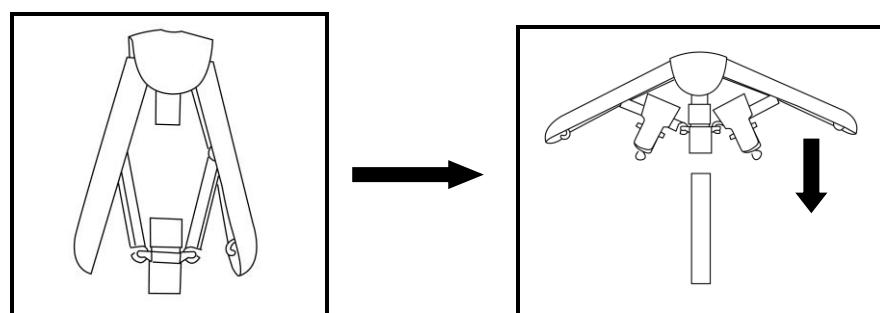
6. Установите держатель распылителя/вешалку на телескопическую стойку.
